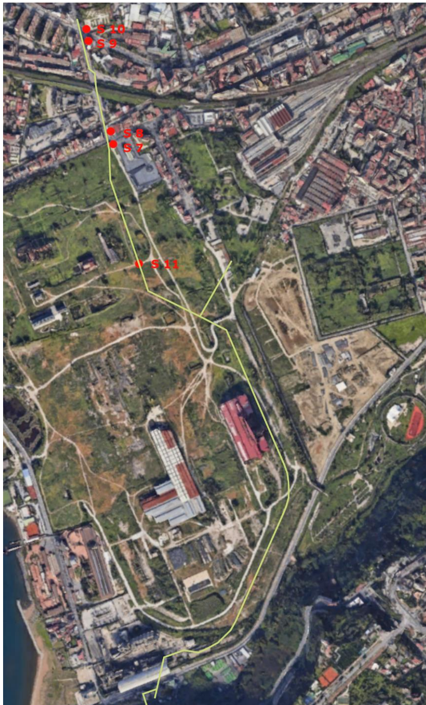
Figura 64 – Ubicazione dei sondaggi in corrispondenza della parte alta del tracciato della Premente B.
