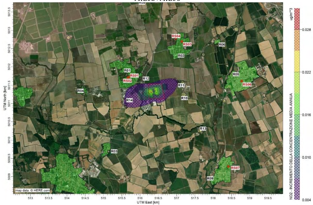
Figura 3-7 – Scenario di Manutenzione - Mappa di dispersione delle concentrazioni di NO 2 (media annua) - MIL05+MIL06
