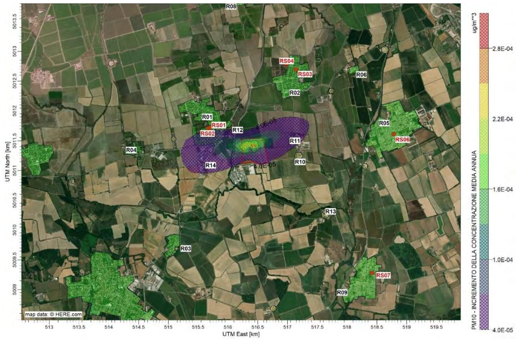
Figura 3-4 – Scenario di Manutenzione - Mappa di dispersione delle concentrazioni di PM10 (media annua) – MIL06
