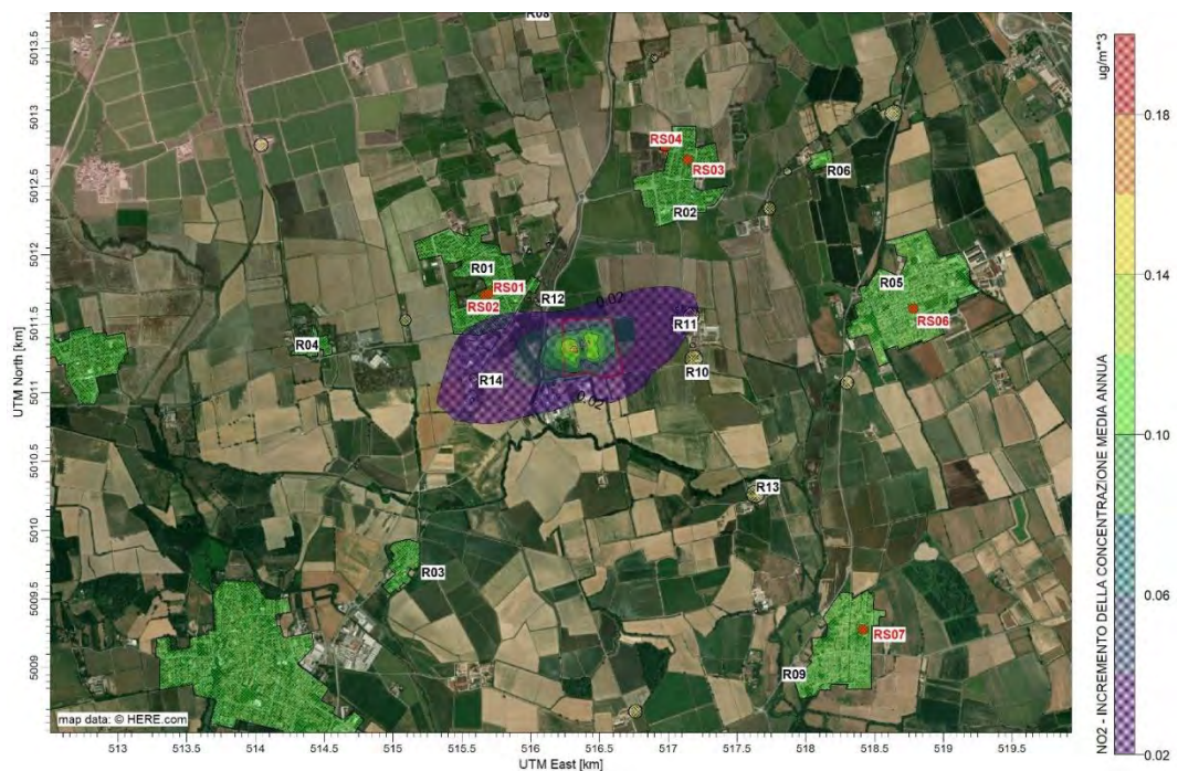
Figura 3-11 – Scenario di Emergenza - Mappa di dispersione delle concentrazioni di NO2 (media annua) - MIL05+MIL06
