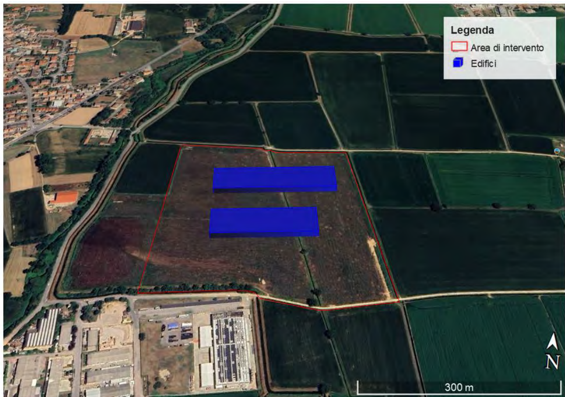
Figura 3-3 – Rappresentazione tridimensionale delle sorgenti simulate (in rosso) e dell'edificio di progetto considerato per calcolare l'effetto di Building Downwash (in blu)
