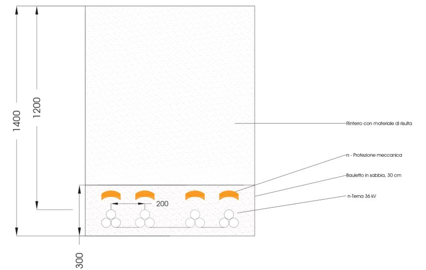
TIPOLOGICO CAVIDOTTO SU STRADA STERRATA - CAVI BT/AC
