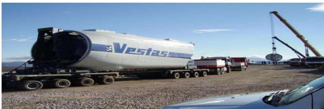
Figura 4. Mezzi per il trasporto della navicella
