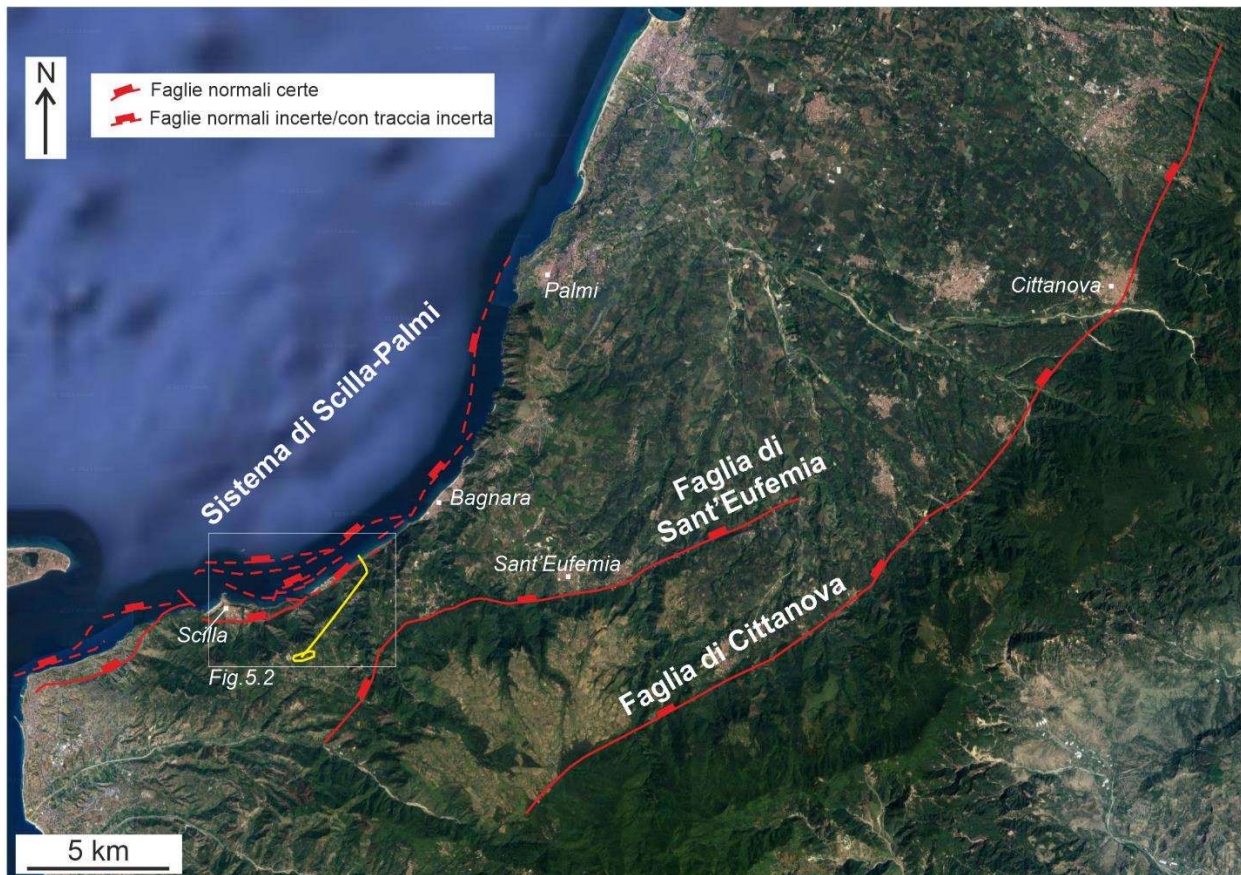
Figura 6.1 Principali faglie attive interessanti l'area di studio. In giallo è riportato l'impianto oggetto di studio.
