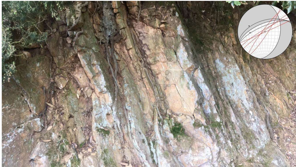
Figura 4.31. Stazione strutturale 4 (14' 31" N -015° 44' 27" E). Le ciclografiche rosse nello stereogramma sono relative a piani di frattura, le ciclografiche nere indicano i piani di faglia e le frecce si riferiscono al cinematisimo osservato.
