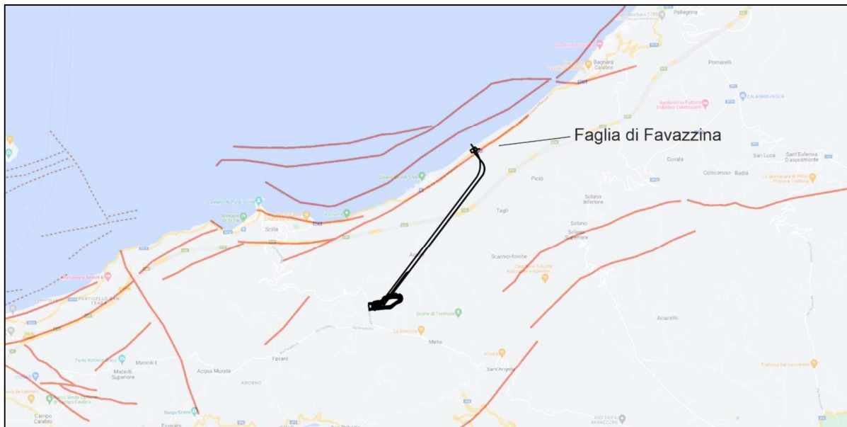
Figura 3.18. Stralcio del database delle faglie capaci ITHACA. In nero è riportato l'impianto oggetto di studio. Si noti come la faglia di Favazzina sia situata in corrispondenza della zona di imbocco della galleria di accesso alla centrale e dell'opera di presa a mare.
