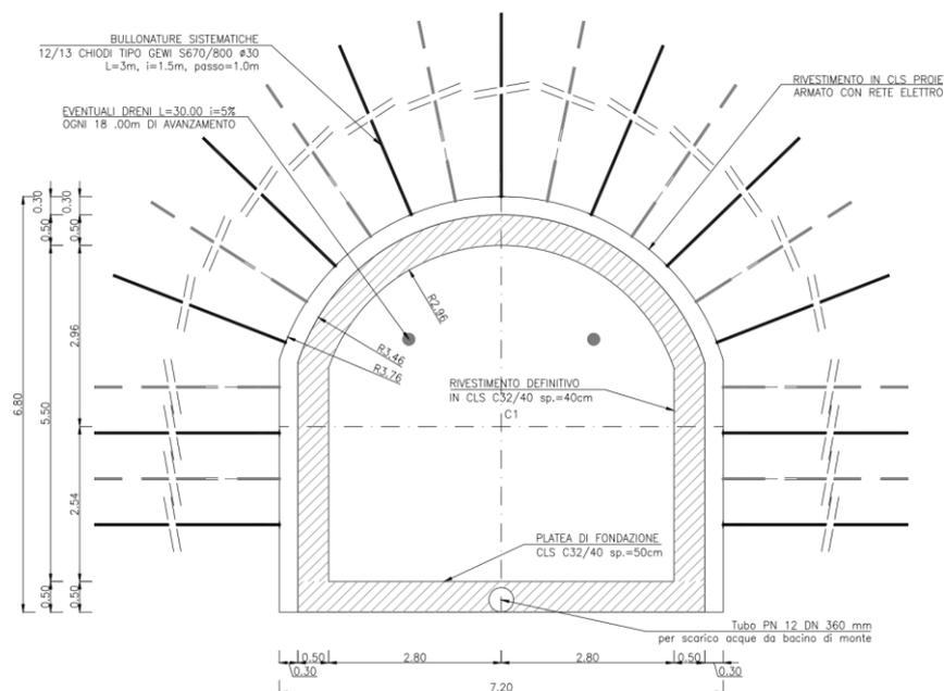
Figura 9 - Sezione tipo GS1 del cunicolo sbarre
