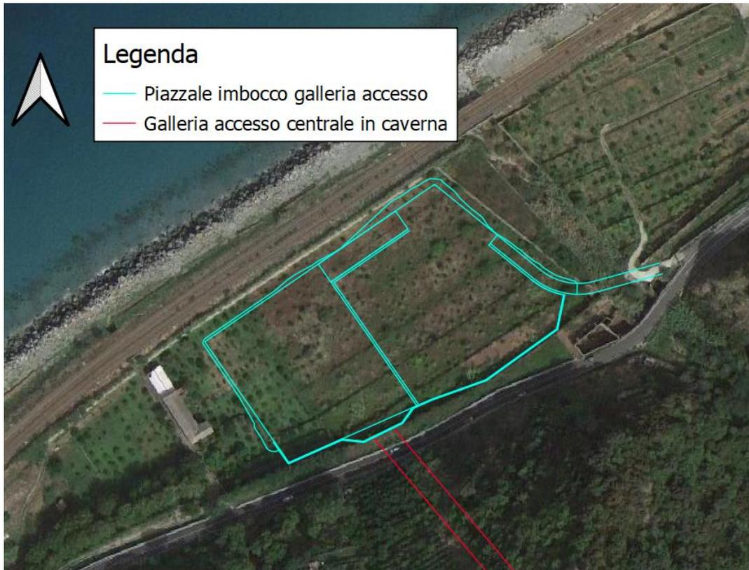
Figura 13 - Planimetria del piazzale posto all'imbocco della galleria d'accesso
