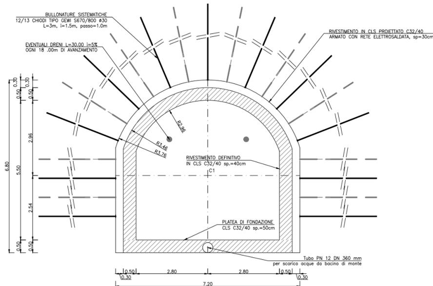
Figura 15 - Sezione tipo GS1 del cunicolo sbarre
