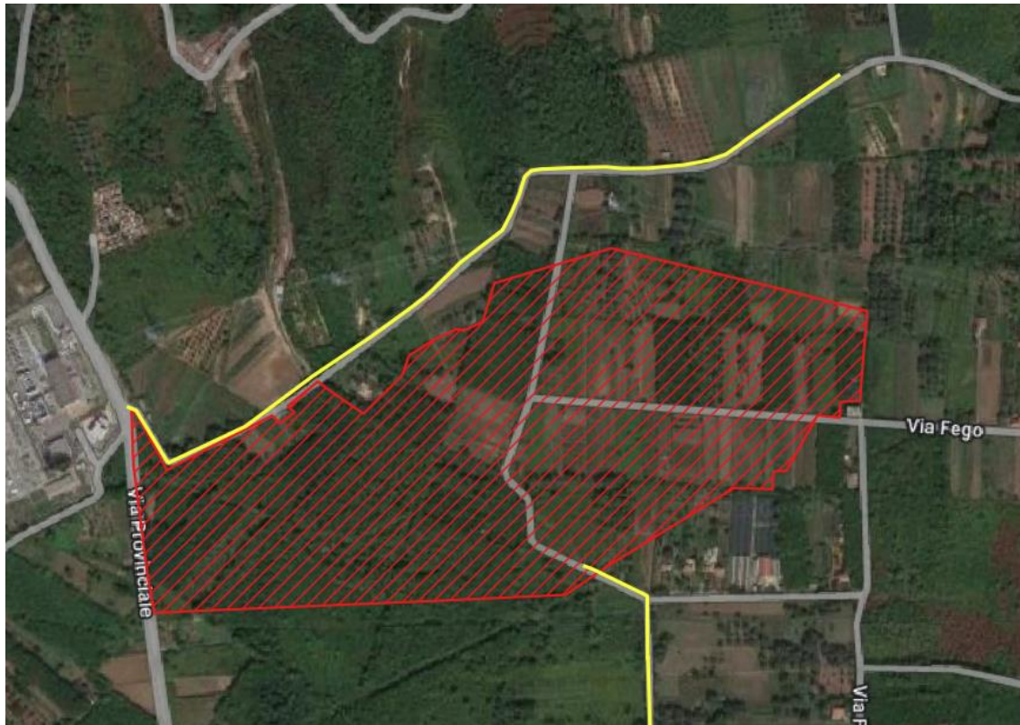
Figura 3 – Area cantiere bacino di monte (in giallo le viabilità da adeguare: a nord viabilità 2 e a sud la viabilità 3)
