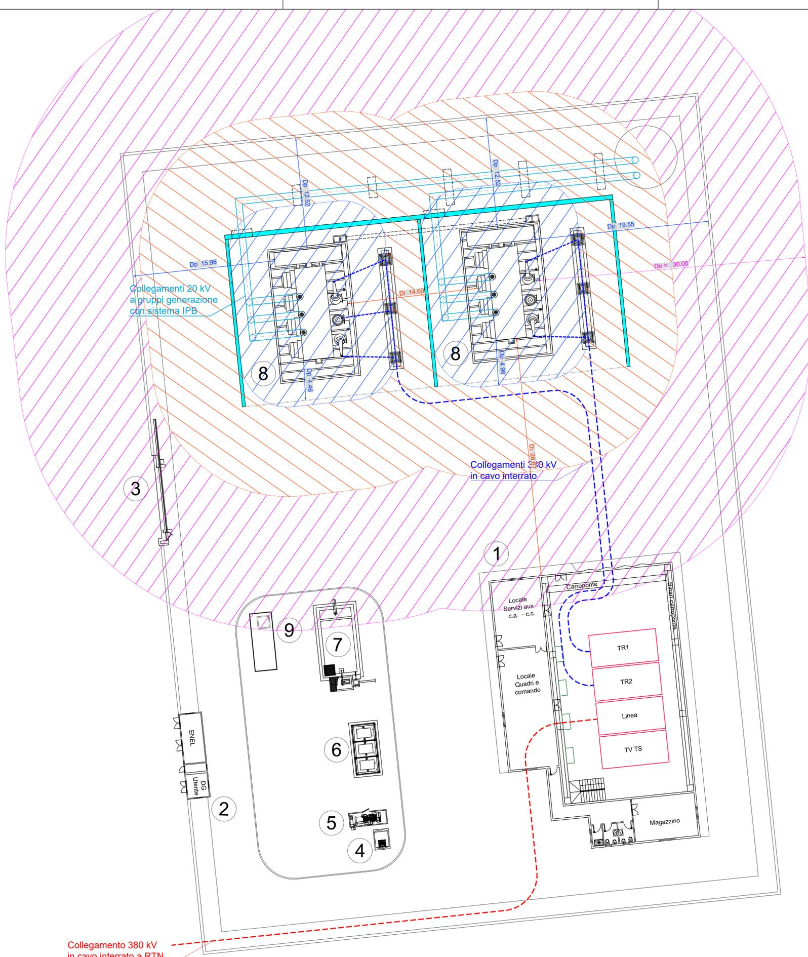
Collegamento 380 kV in cavo interrato a RTN
