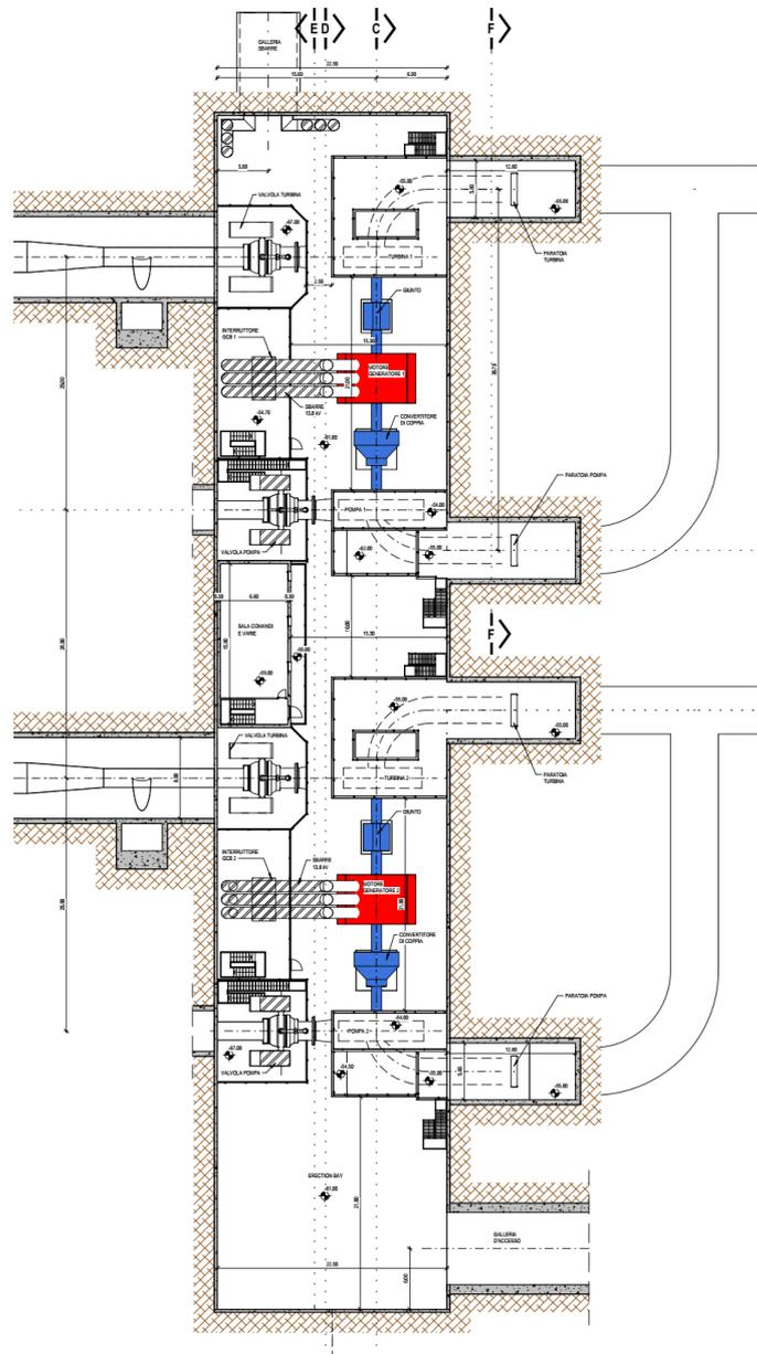
Figura 3.3: Pianta della centrale – dettaglio della sala macchine
