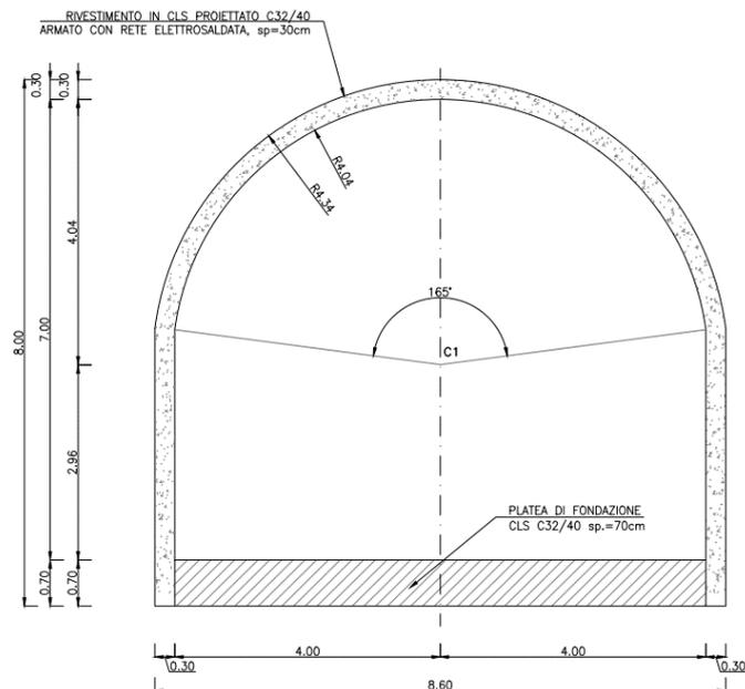
Figura 3.7: Sezione tipo GA 1 della galleria di accesso alla centrale
