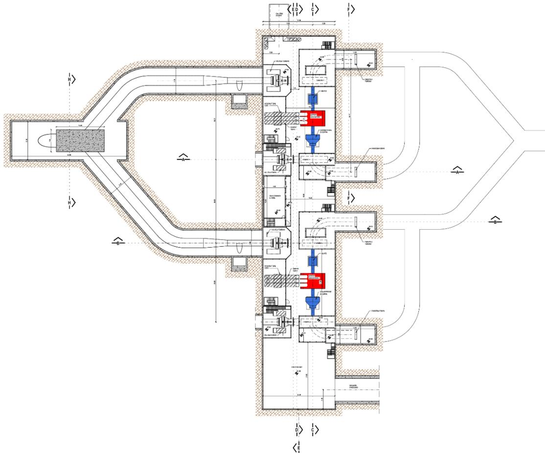
Figura 3.4: Pianta della centrale e biforcazioni di monte e di valle
