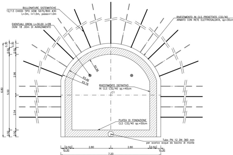
Figura 3.9: Sezione tipo GS1 del cunicolo sbarre
