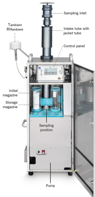
Figura 4-1 Campionatore sequenziale automatico
