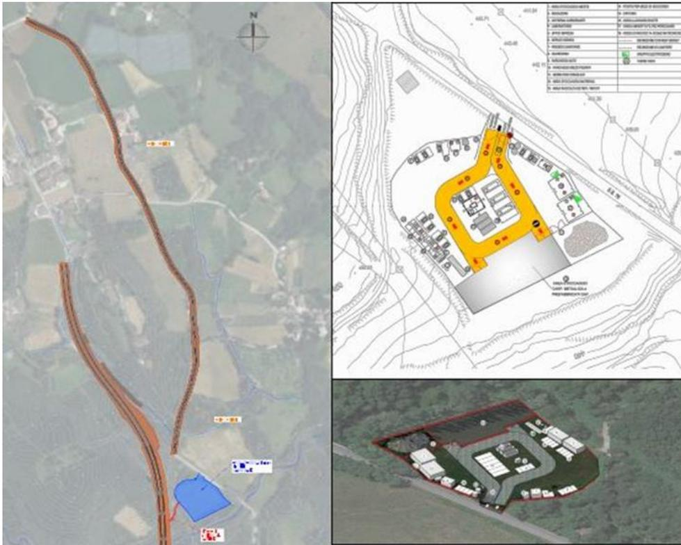
Figura 28: Planimetria e dettagli relativi all'area di cantiere
