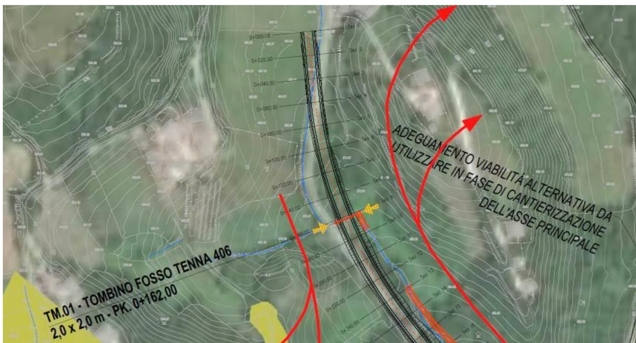
Figura 17: Opere d'arte di progetto – Attraversamento TM.01
