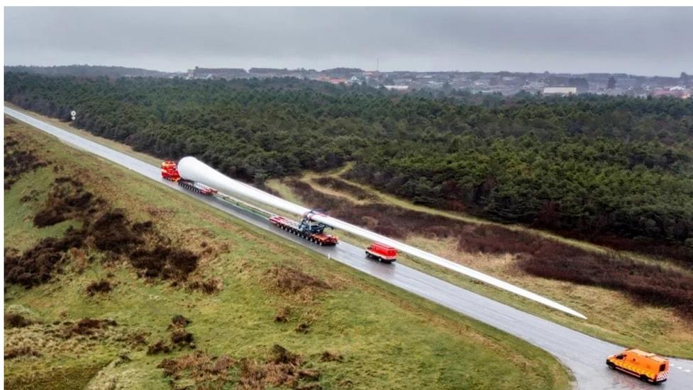
Figure 12 – Trasporto sezione pala
