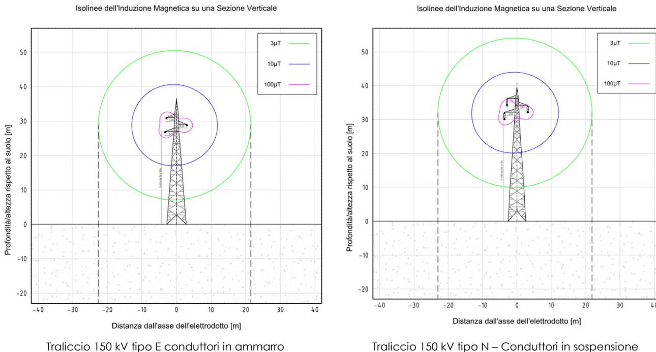
**Figura 2 - Isolinee del campo magnetico B, valori: 100μT, 10μT e 3 μT alla quota testa tralicci -**
