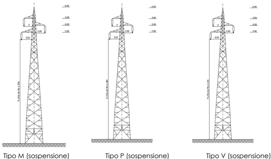
Figura 1 - Pali unificati 150 kV – Semplice terna – in amarro ed a sospensione
