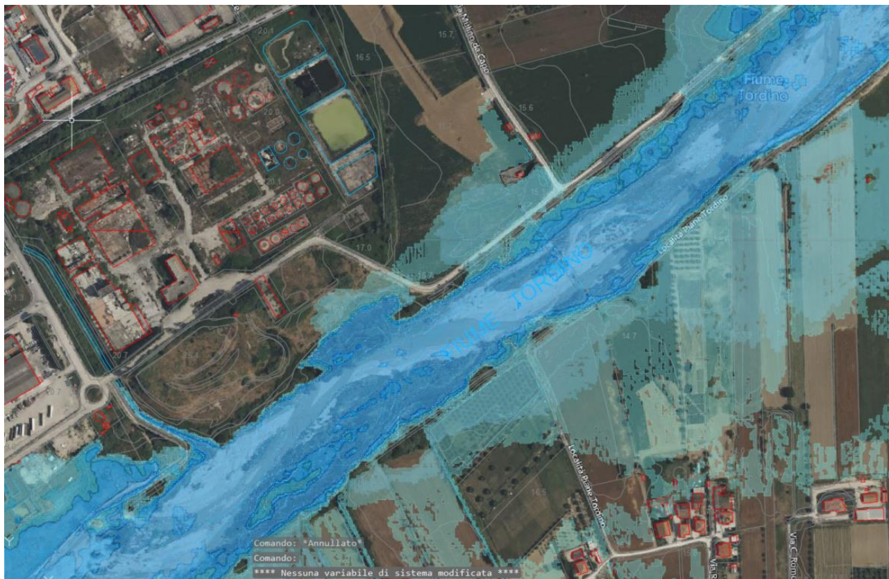
Mappa dei tiranti idrici per evento con T_R di 200 anni – stato Ante-operam
