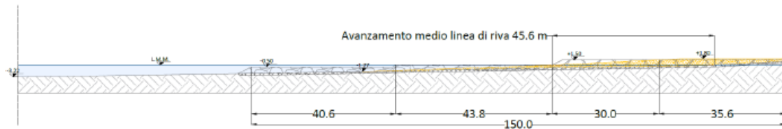
Figura 3.57: Sezione trasversale tipologica dei pennelli
