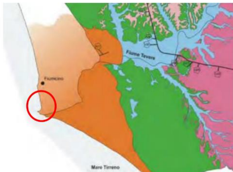
Figura 4.11: Stralcio carta delle unità idrogeologiche (Capelli e Mazza 2005) In arancio l'Unità Idrogeologica del Delta del Tevere, in verde l'Unità Idrogeologica di Ponte Galeria, in viola l'Unità Idrogeologica dei Colli Albani, in rosa l'Unità Idrogeologica dei Monti Sabatini, in azzurro l'Unità Idrogeologica dei depositi alluvionali recenti e attuali
