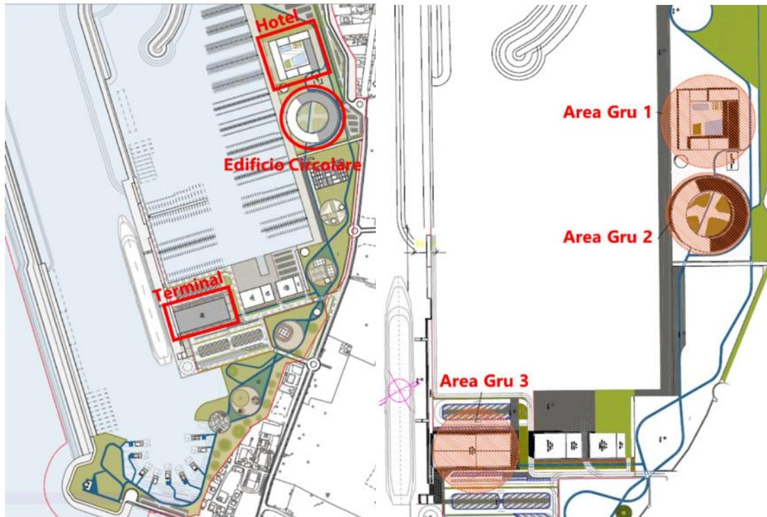
Figura 4.57: Aree di influenza delle gru durante le fasi di cantierizzazione del progetto e Edifici principali previsti presso il nuovo porto di Fiumicino – Isola Sacra
