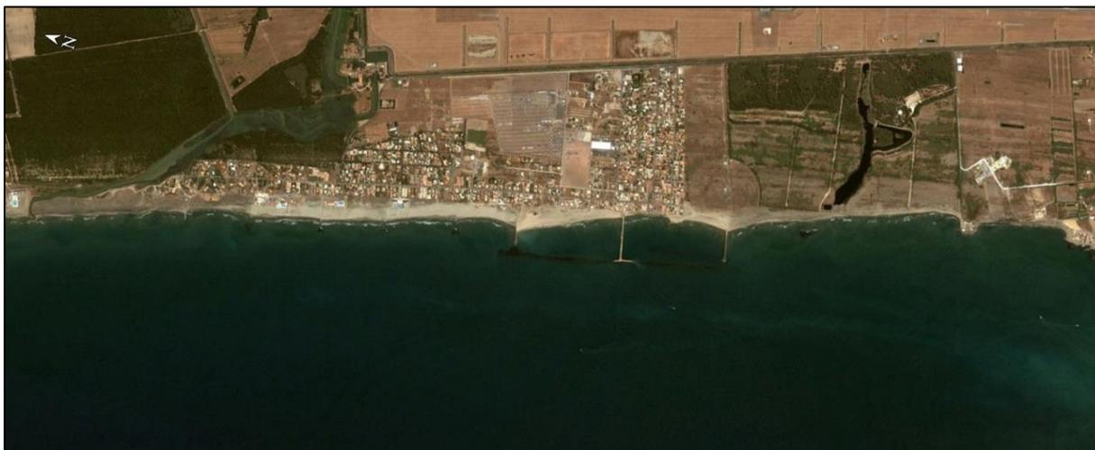
Figura 3.6: Litorale di Focene (2003); realizzazione dei pennelli a protezione
