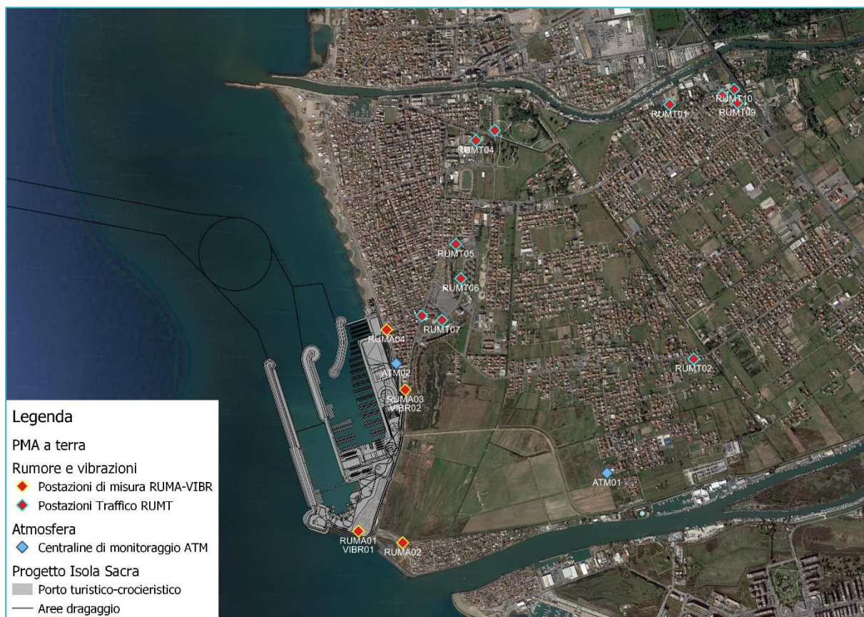
Figura 3.2: Ubicazione dei punti di monitoraggio a terra delle componenti rumore, vibrazioni, atmosfera.
