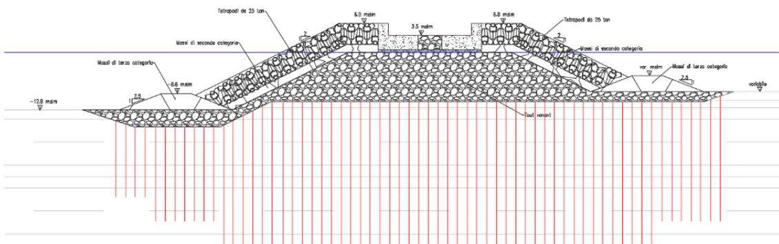
Figura 3-3 Sezione tipo della testata (Sec. C)
