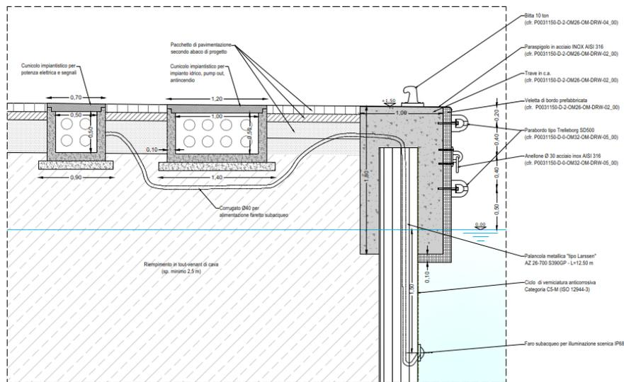
Figura 3-14 Dettaglio della sezione della banchina di riva
