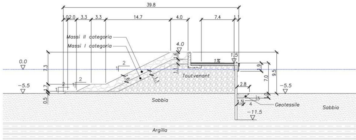
Figura 3-10. Sezione radice di collegamento a terra (Sez. O)
