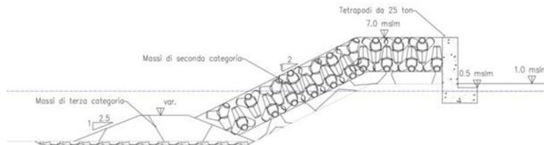
Figura 3-4 Sezione tipologica dell'area del faro (Sez. K)
