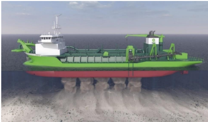
Figura 5-21: Rilascio del materiale sul fondale marino (dumping)
