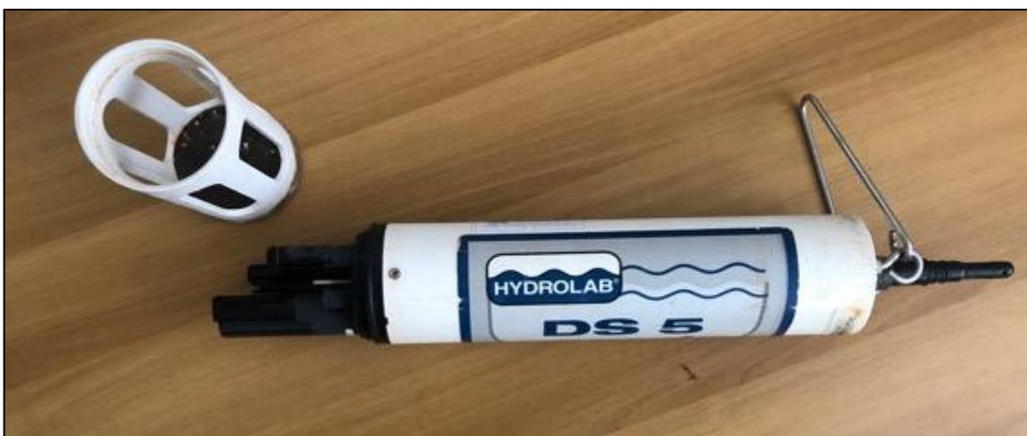
Figura 8 - Sonda multiparametrica Hydras DS5.
