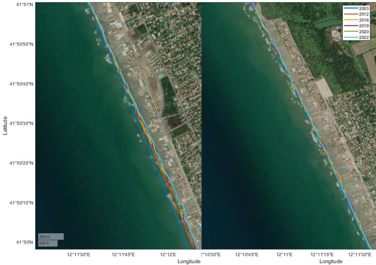
**Figura 21 - Zoom dell'evoluzione delle linee di riva in corrispondenza di Fregene Sud a sinistra e Fregene Nord a destra**
