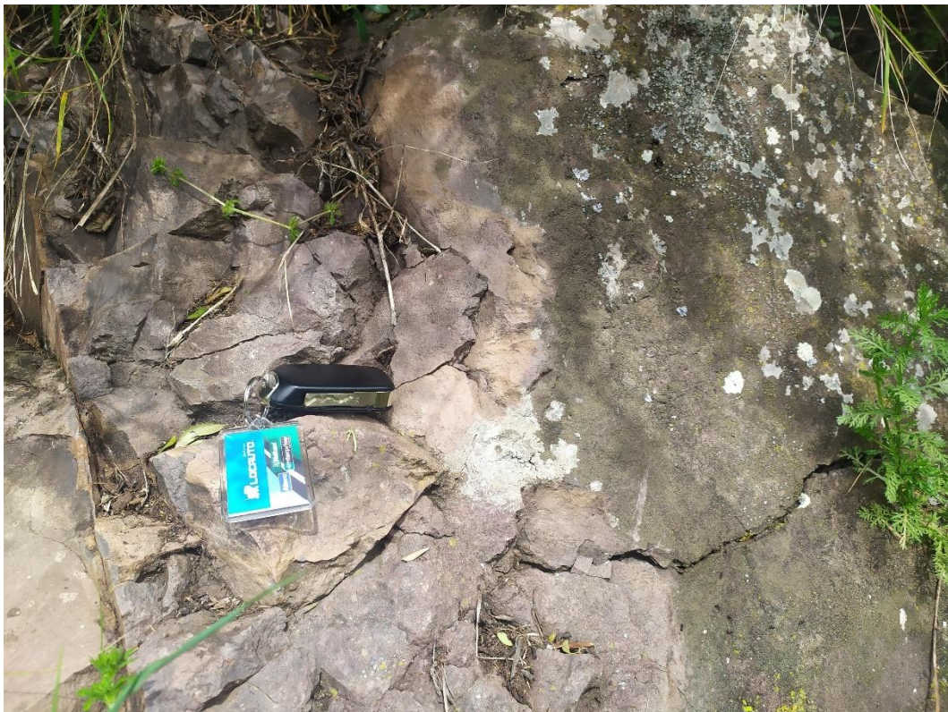
Figura 19: Basalti-trachibasalti della Subunità di Funtana di Pedro Oe, qui in parte molto fratturati, con fratturazione irregolare a circa 700 m dalla WTG M2_06.
