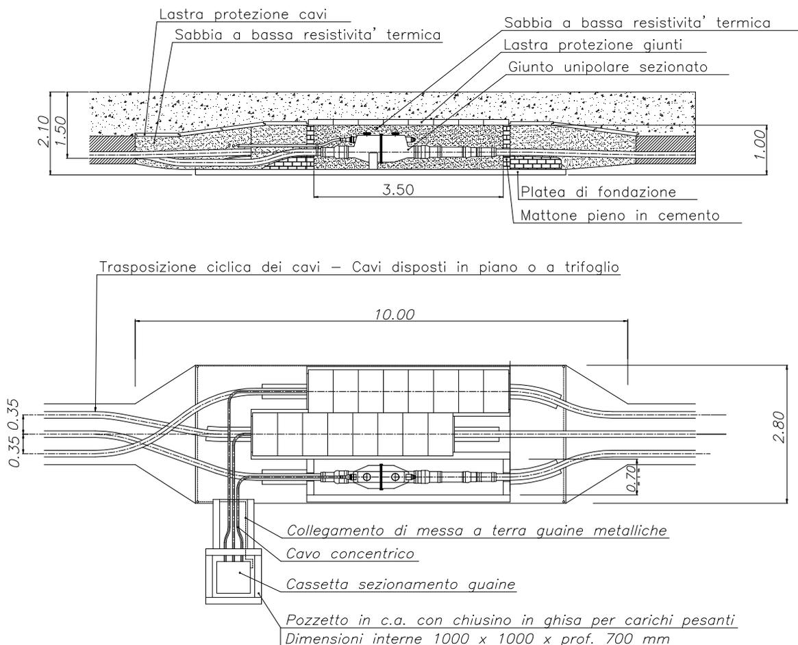
Gli schermi metallici intorno ai conduttori di fase dei cavi con isolamento estruso hanno la funzione principale di fornire una via di circolazione a bassa impedenza alle correnti di guasto in caso di cedimento di isolamento. Pertanto essi saranno dimensionati in modo da sostenere le massime correnti di corto circuito che si possono presentare.
