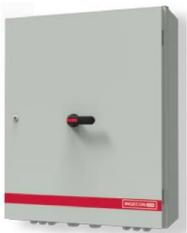
Lo StringBox (quadro parallelo) è l'elemento che raggruppa le stringhe, esso ha il compito di convogliare l'energia elettrica proveniente dalle stringhe fotovoltaiche e di indirizzarla verso l'inverter per la conversione in corrente alternata.
