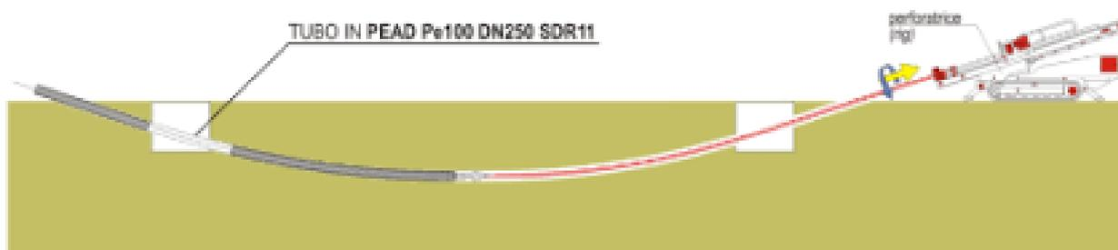
Figura 11 - trivellazione orizzontale "(tecnologia T.O.C)
