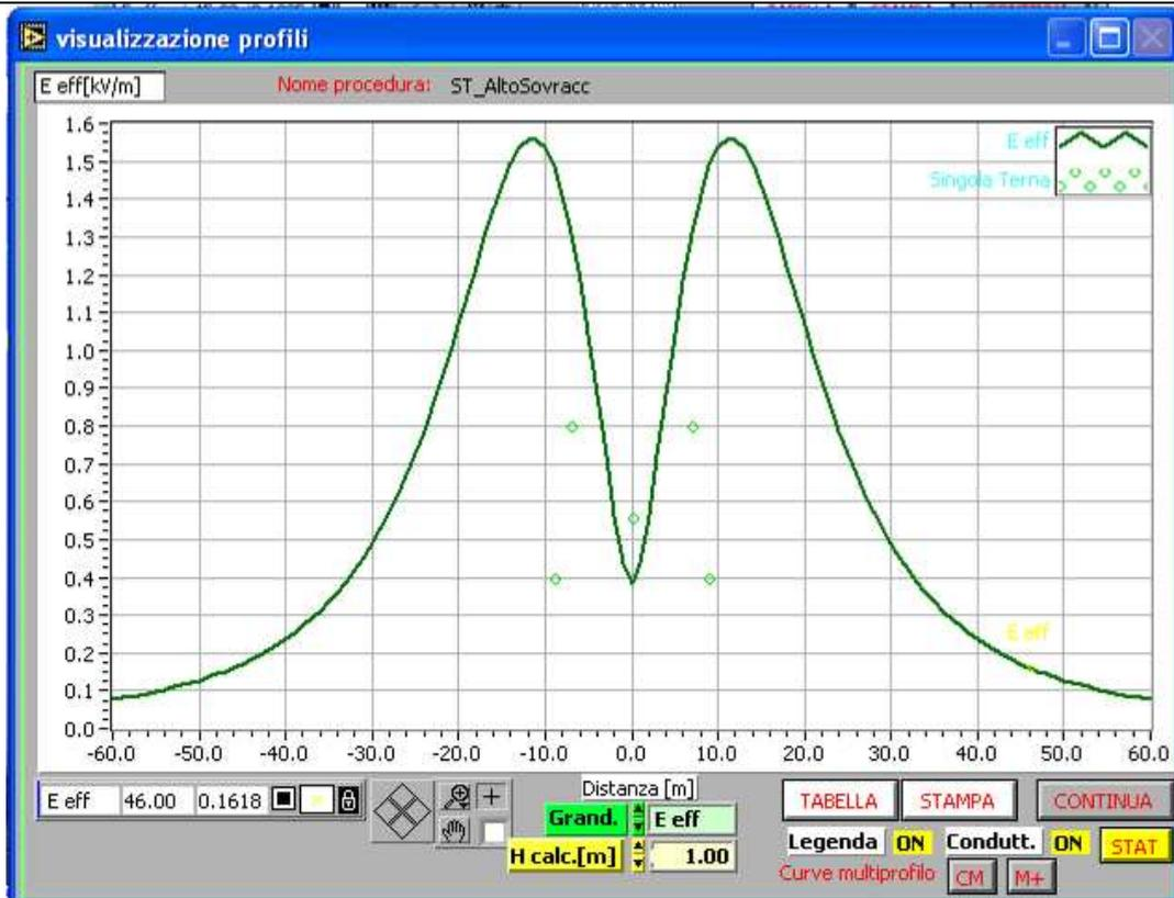
**SOSTEGNO A TRALICCIO SINGOLA TERNA 380 kV ALTO SOVRACCARICO TIPO G1: andamento del campo elettrico a 1 m dal suolo considerando l'altezza dei conduttori in centro campata**
