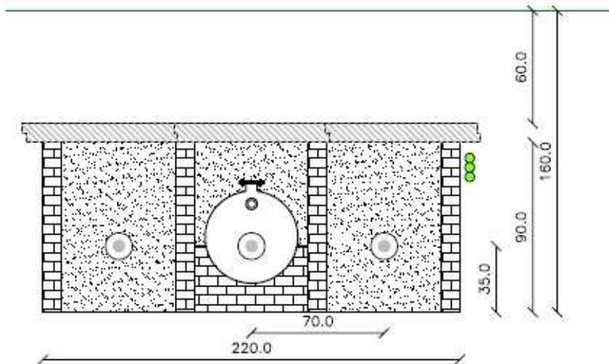
I cavi saranno interrati ed installati normalmente in una trincea della profondità di 1,6 m.
