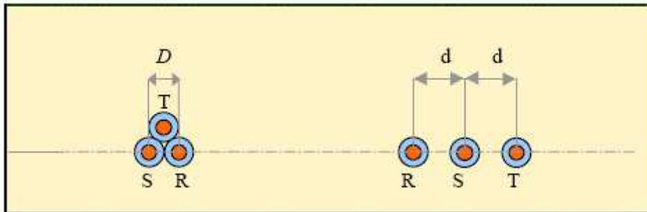
La posa a trifoglio riduce la portata di corrente ammissibile del cavo dovuta al regime termico che si instaura a causa della vicinanza dei cavi. Al contrario la posa in piano presenta livelli di portata in corrente proporzionali alla distanza di interasse dei cavi, ed è usualmente utilizzata in corrispondenza delle "buche giunti", come rappresentato di seguito.
