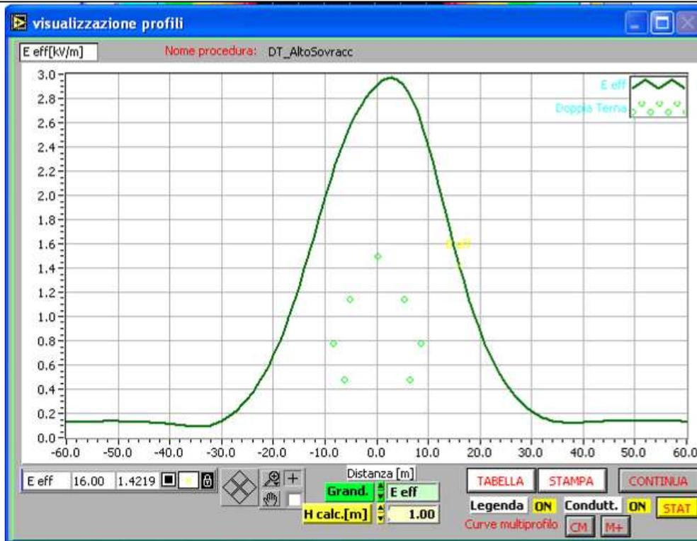
**SOSTEGNO A TRALICCIO DOPPIA TERNA 380 kV ALTO SOVRACCARICO TIPO P: andamento del campo elettrico a 1 m dal suolo considerando l'altezza dei conduttori in centro campata**
