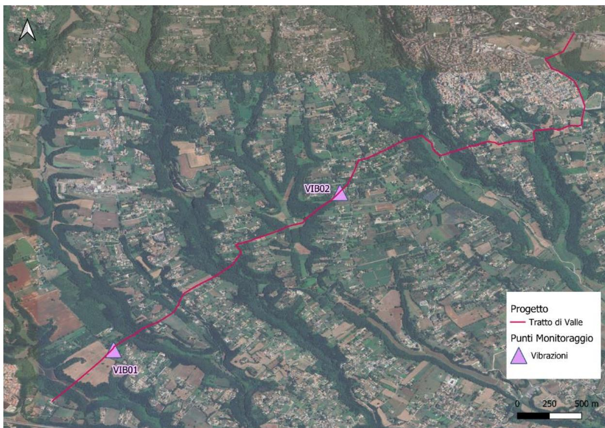
Figura 18 Area di indagine con indicazione dei punti di misura – Componente Vibrazioni
