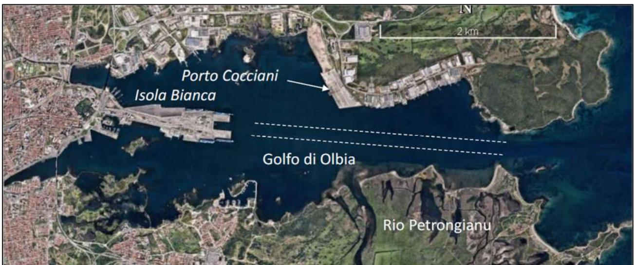
Figura 5. Inquadramento del Porto di Olbia con evidenza del porto commerciale (Isola bianca), del porto industriale (Porto Cocciani) e del canale di accesso, denominato Canaletta (rappresentato con linea tratteggiata)
