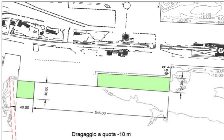
Figura 38: Pontile Isola Bianca: Vasche di colmata attracchi 8 e 9. Da ATF proposto dall'AdSP
