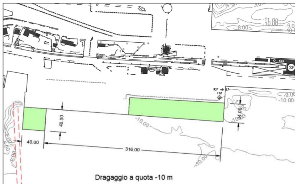
Figura 3: Pontile Isola Bianca: Vasche di colmata attracchi 8 e 9. Da ATF proposto dall'AdSP
