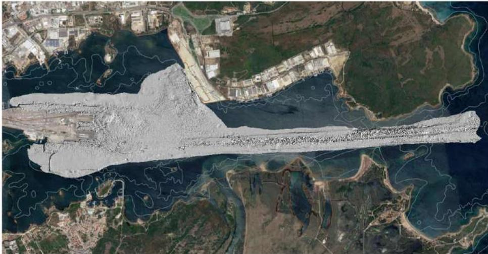
Figura 179. Vista tipo Shaded relief estratta dal DTM ad alta risoluzione in scala di grigi
