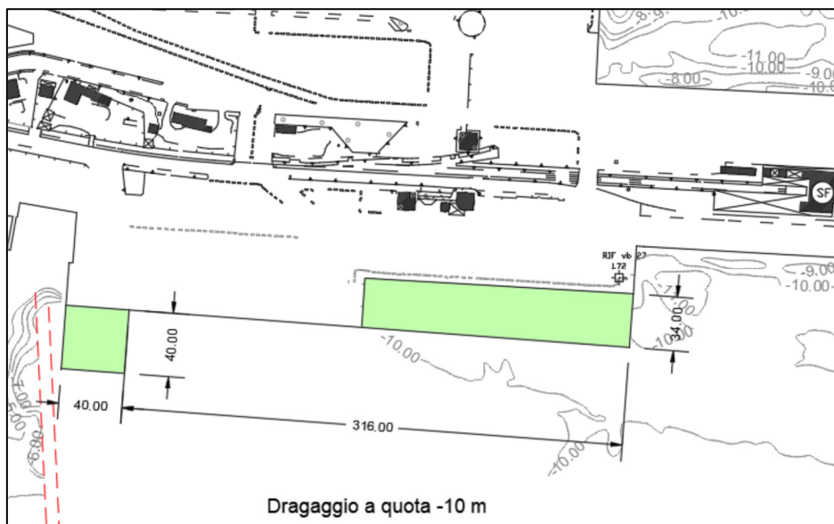
Figura 10: Pontile Isola Bianca: Vasche di colmata attracchi 8 e 9. Da ATF proposto dall'AdSP
