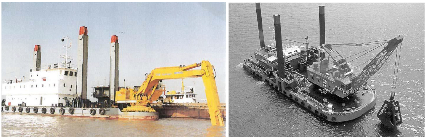
Figura 11. Motonave pontone con escavatore idraulico a braccio rovescio a sinistra e con escavatore tralicciato a funi a destra
