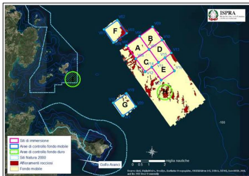
Figura 16. Rappresentazione GIS del possibile sito di immersione (A,B,C,D, E) con le aree di controllo del fondo duro (H, I) e molle (F, G). Fonte: Studio di fattibilità dell'area di immersione dei sedimenti da dragare nel Porto di Olbia. Convenzione ISPRA – AdSP del Mar di Sardegna – Report 2 - Luglio 2021
