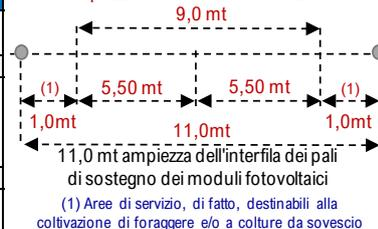
11,0 mt ampiezza dell'interfila dei pali di sostegno dei moduli fotovoltaici
