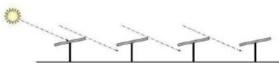
Seguendo un principio di standardizzazione del campo fotovoltaico si cercherà di limitare al massimo le tipologie di inseguitori, gestendoli in modo da garantire un cablaggio della parte in corrente continua omogeneo per tutto il sito. La lunghezza del singolo inseguitore sarà pertanto in funzione della lunghezza delle stringhe fotovoltaiche. In particolare si prevedranno tre tipologie di inseguitori:
