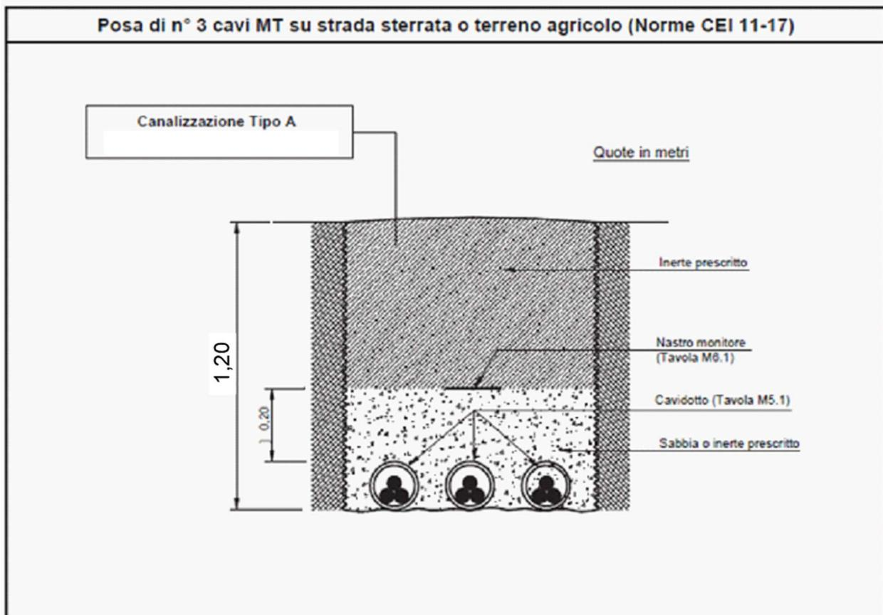
Figura 2- Dettaglio sezione di scavo
