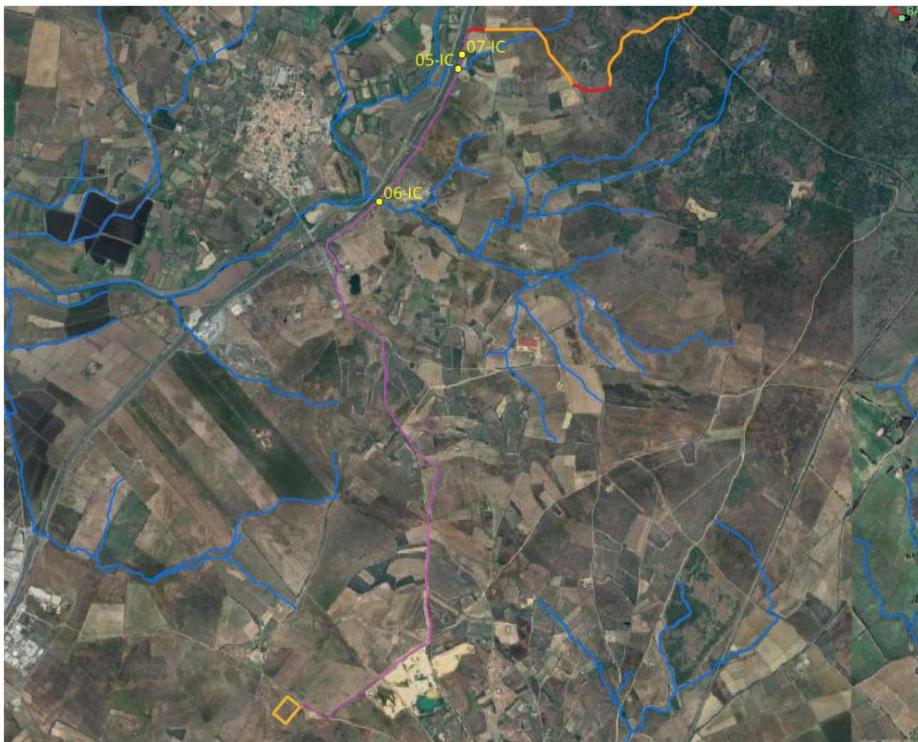
Figura 1.5: Planimetria cavidotti su IGM con individuazione del reticolo idrografico della Regione Sardegna (in magenta è indicato il cavidotto)
