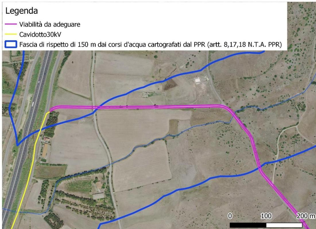
Figura 1.5 – Sovrapposizione del cavidotto MT, ivi impostato su viabilità esistente, e tratto di viabilità da adeguare con fascia di 150m di tutela paesaggistica del “Roia Pardu”
