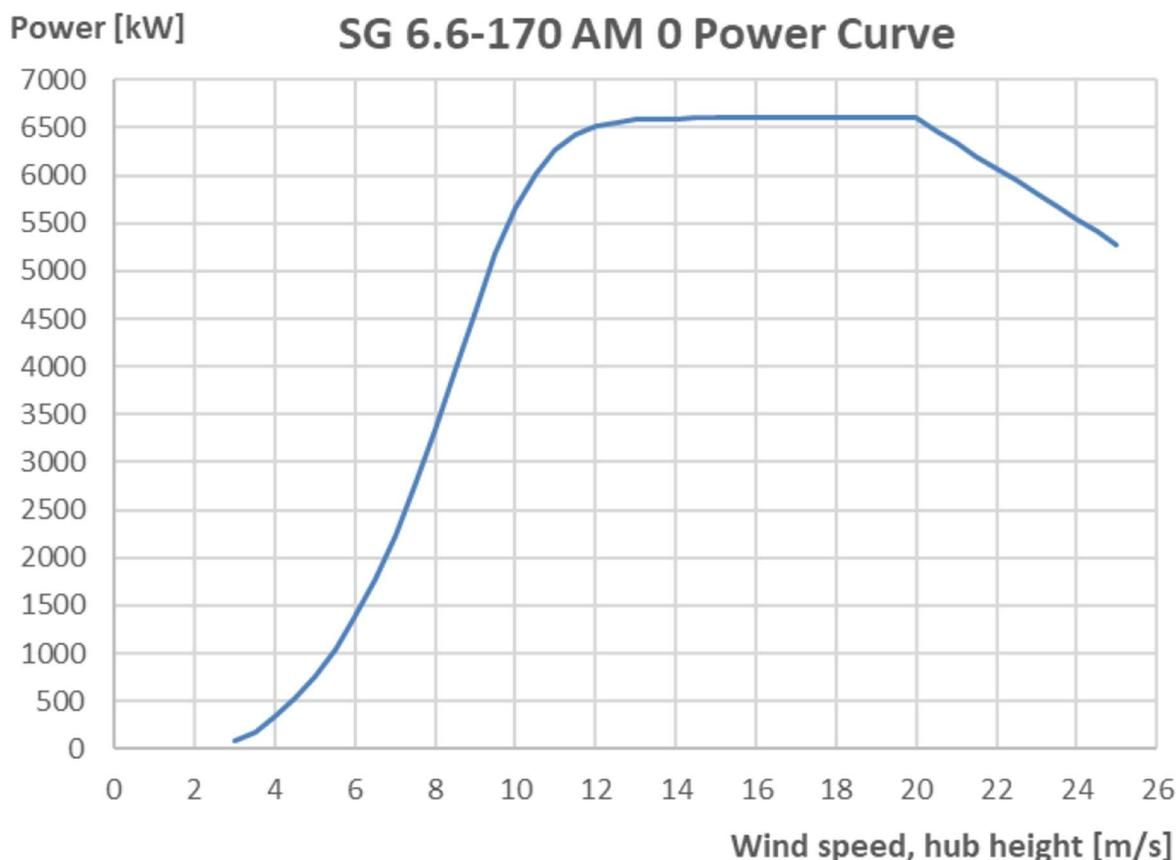
Figura 2.3 – Curva di potenza generatore tipo SG 6.6-170
