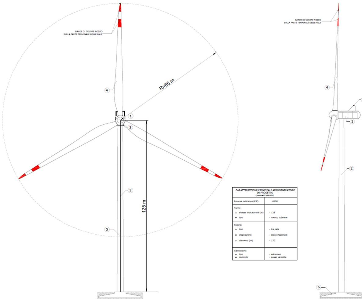
Figura 2.2 – Aerogeneratore tipo SG170 altezza al mozzo (1) 125 m, e diametro rotore (2) di 170 m
