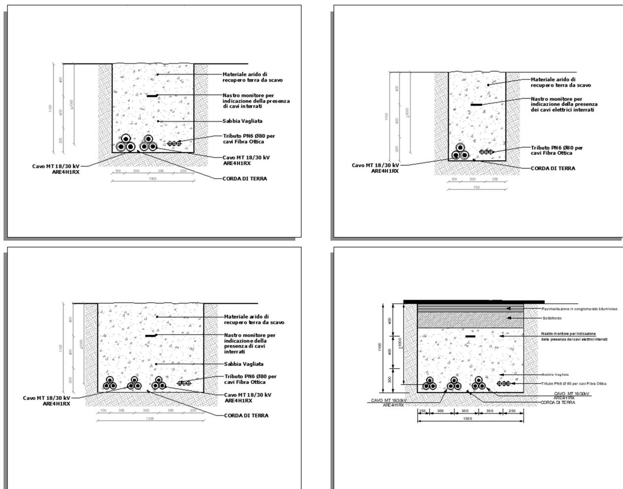
Figura 3.3 – Tipico modalità di posa Cavo MT 30 kV
