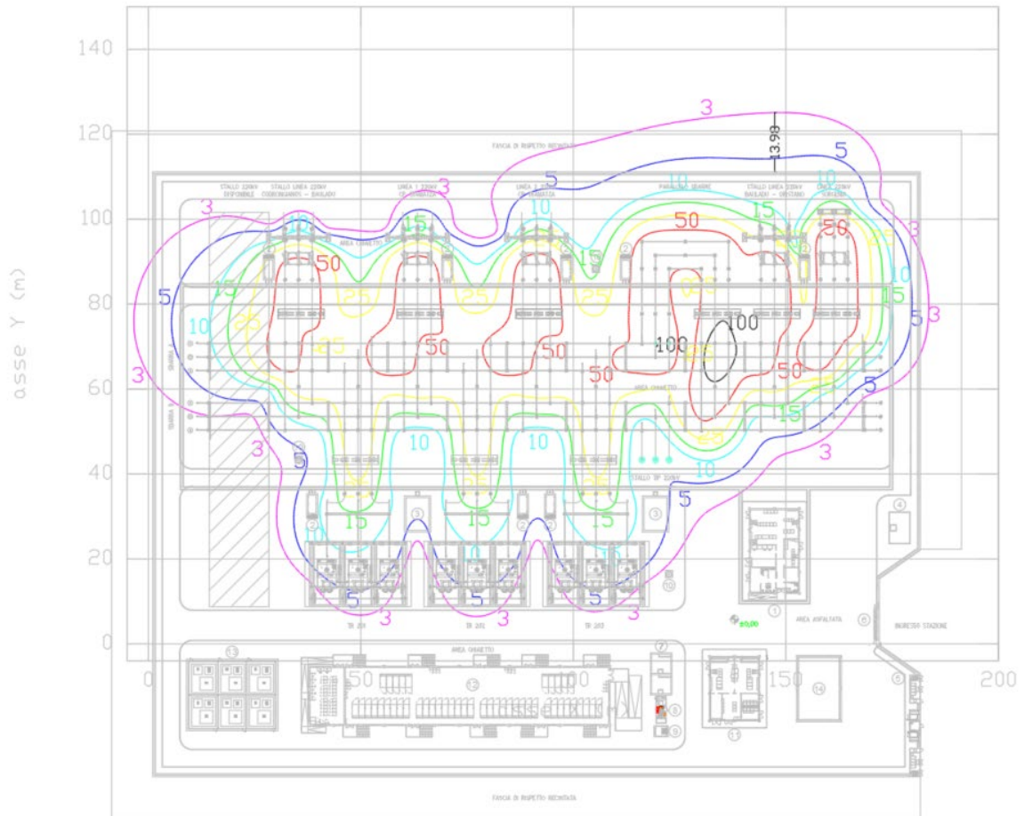
Figura 5 – Livelli di campo magnetico a 1 m dal piano della stazione
