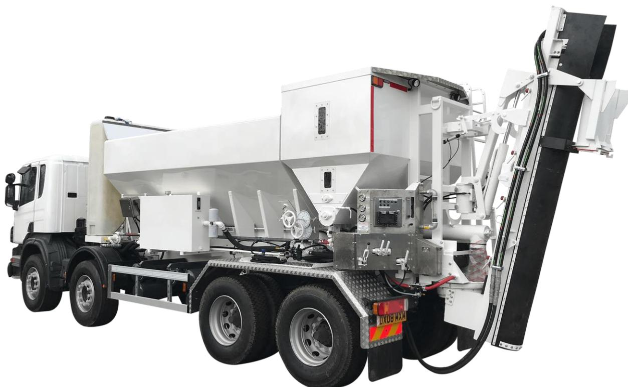
**Impianto di betonaggio mobile**
