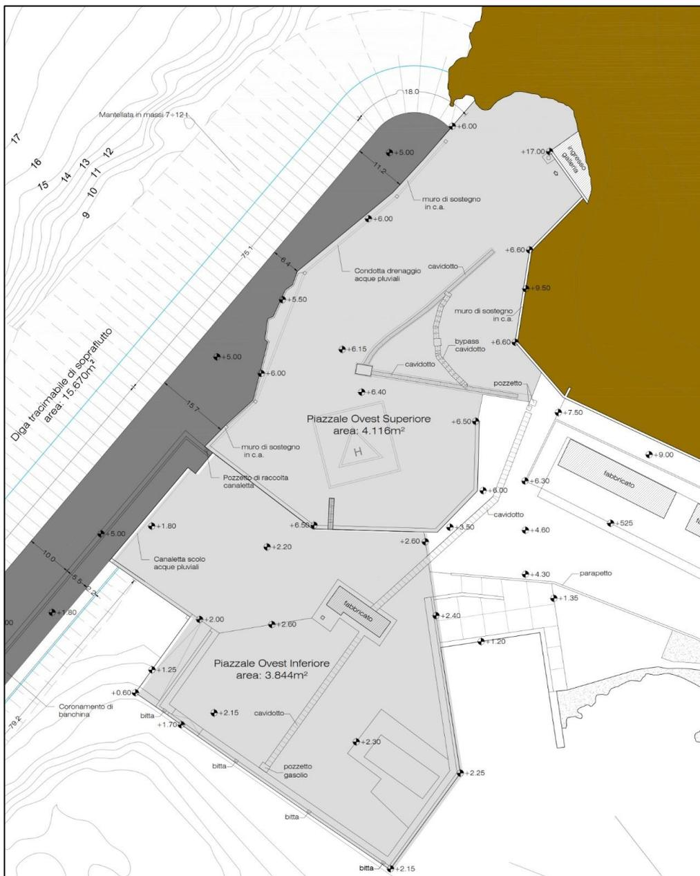
Figura 3.2 – Planimetria con indicazione della sistemazione dei piazzali superiore e inferiore)
