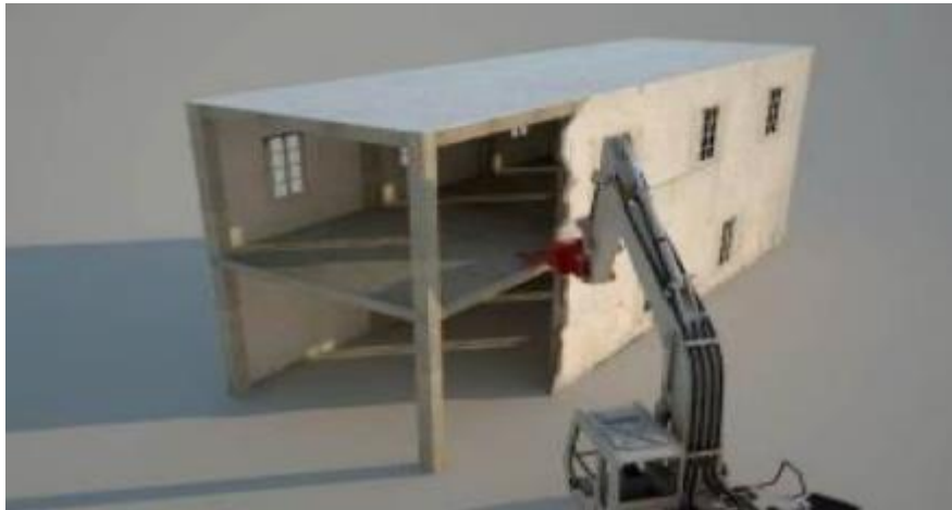
Figura 6.3- Sequenza operativa demolizione (b)
