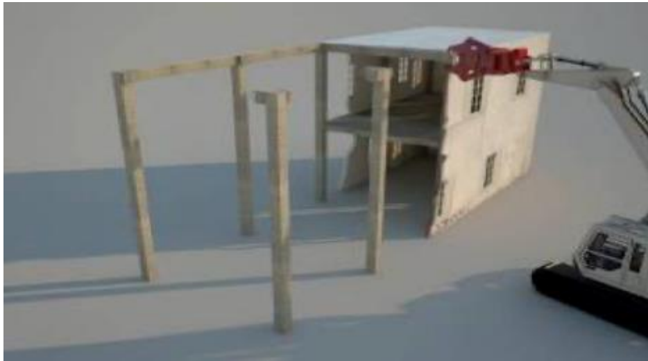
Figura 6.9- Sequenza operativa demolizione (g)
