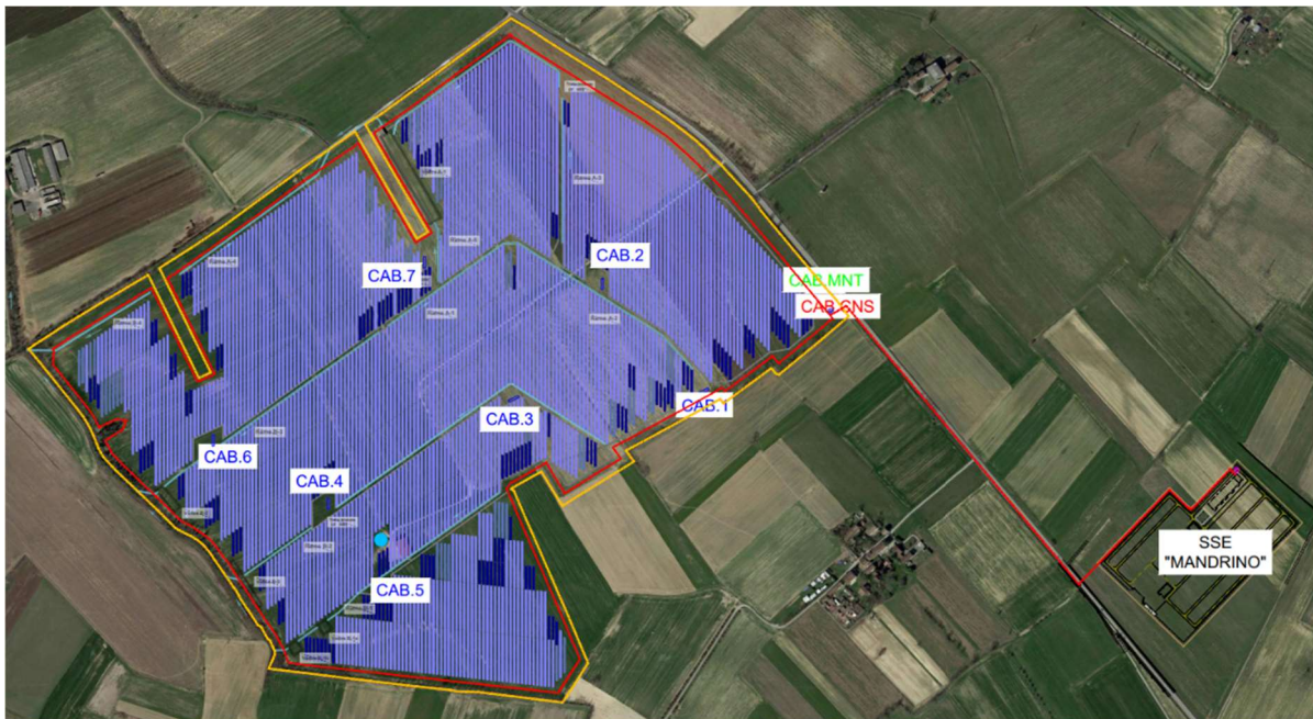
Figura 1. Individuazione dell'area di impianto, dei lotti e dei punti di consegna AT
