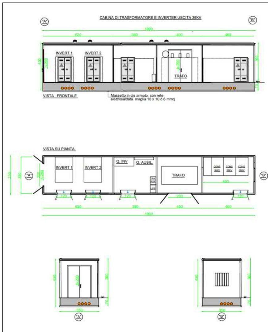
Figura 3. Planimetria e prospetti dell'unità di trasformazione
