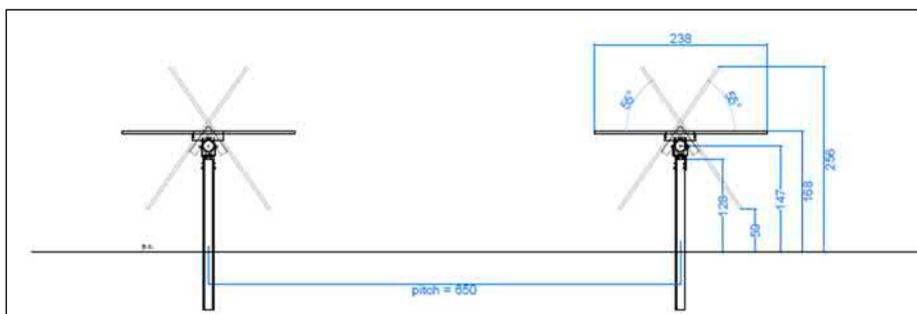
Figura 2 - Particolare strutture di sostegno moduli
