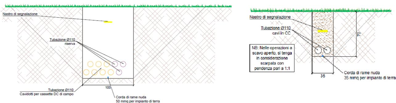
Figura 5.4: Tipologici di scavo.
