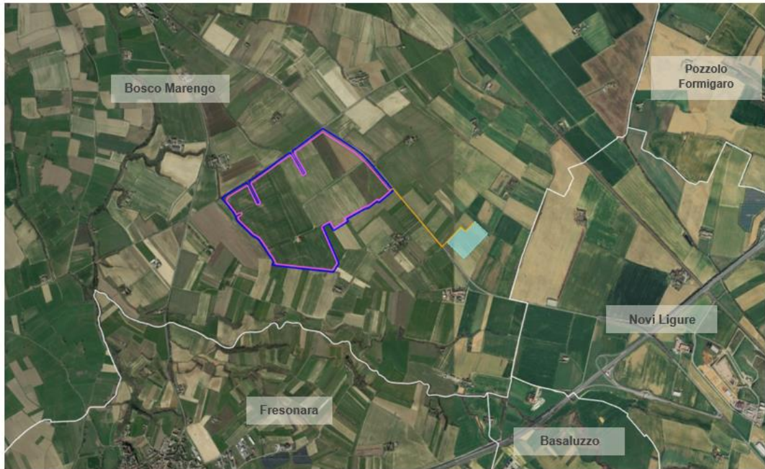
Figura 2. Localizzazione dell'area di intervento e relative opere di rete su foto satellitare: linea blu= superficie catastale; linea magenta= area di impianto; linea arancione= cavidotto di connessione; puntalino rosso = punto di connessione alla SE "Mandrino" (Fonte cartografica di base: Google Earth).
