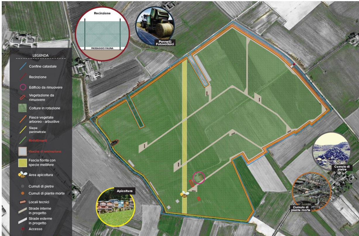
Figura 50. Layout relativo agli interventi di mitigazione ambientale in progetto, con rappresentazione grafica della componente ambientale del progetto (colture in rotazione, fascia fiorita con specie mellifere, fasce arboreo-arbustive, microhabitat per la fauna locale).
