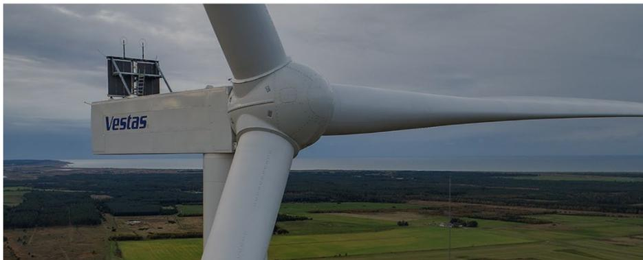
*Figura 2: Tipico aerogeneratore Vestas V162-7,2 MW*
