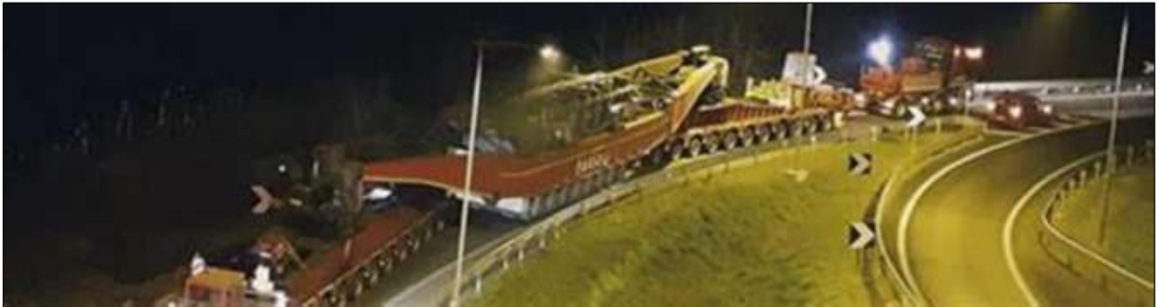
Figura 8: Tipico convoglio con spalle e semirimorchi in svincolo autostradale
