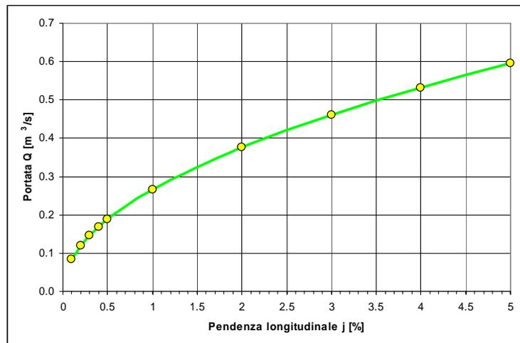
Figura III.4.1 – Portata massima smaltibile in funzione della pendenza longitudinale
