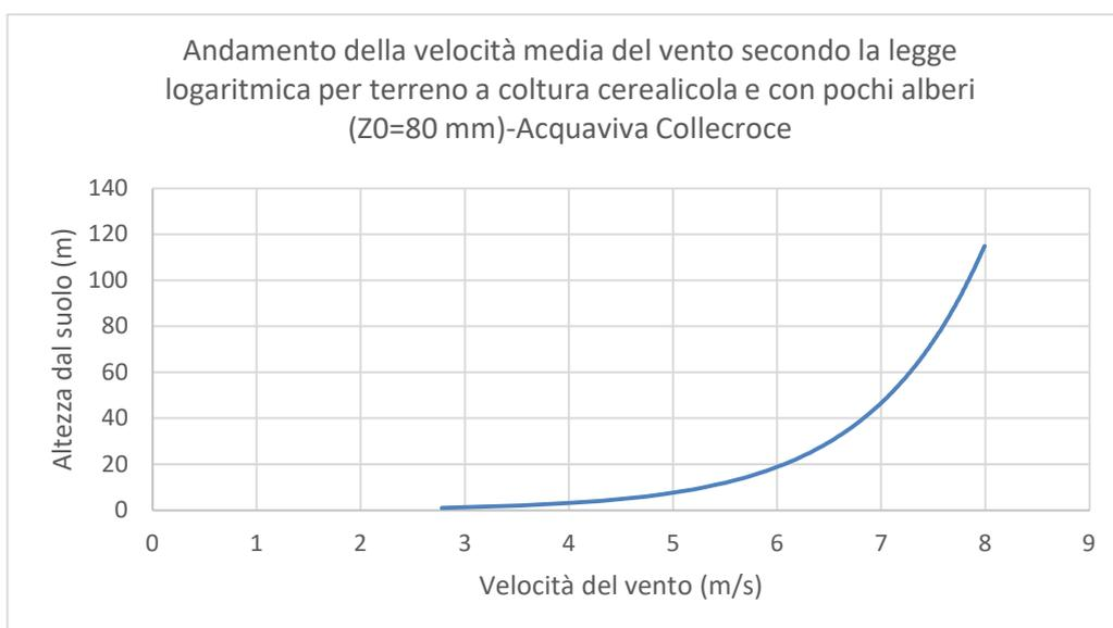
**Figura 7 – Acquaviva Collecroce EO\_ Andamento della velocità media del vento secondo la legge di propagazione logaritmica per terreni a coltura cerealicola ( $U_{zr}=4,4$  m/s e  $z_r= 3$  m)**
