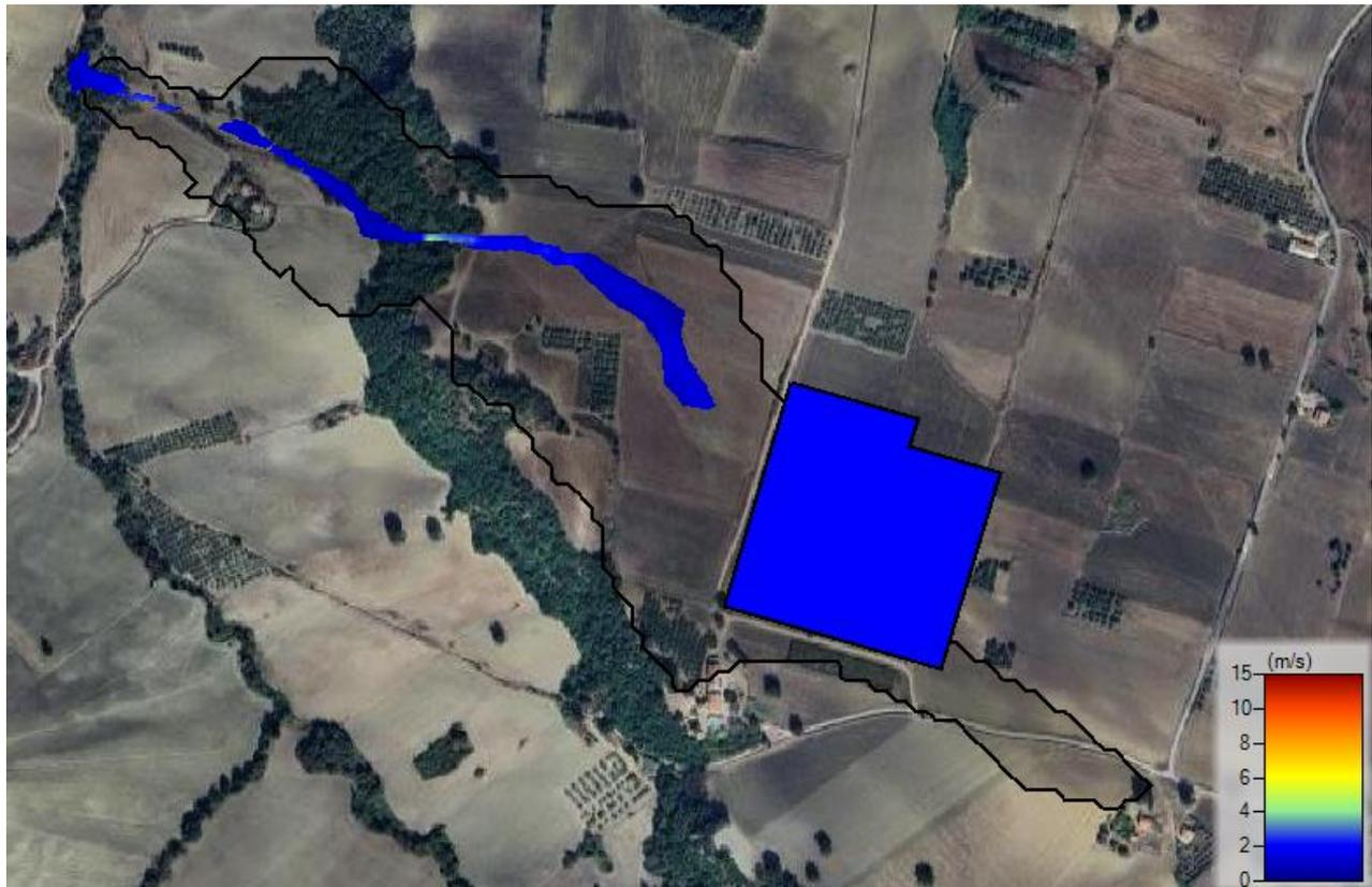
Figura 3-20 Velocità della corrente (velocity) per effetto della propagazione della portata di picco corrispondente a  $Tr = 200$  anni per il corso d'acqua del sottobacino 1
