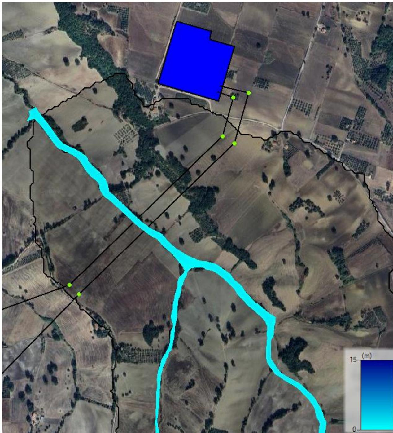
Figura 3-25 Altezza (Depth) per effetto della propagazione della portata di picco corrispondente a  $T_r = 200$  anni per il corso d'acqua del sottobacino 4
